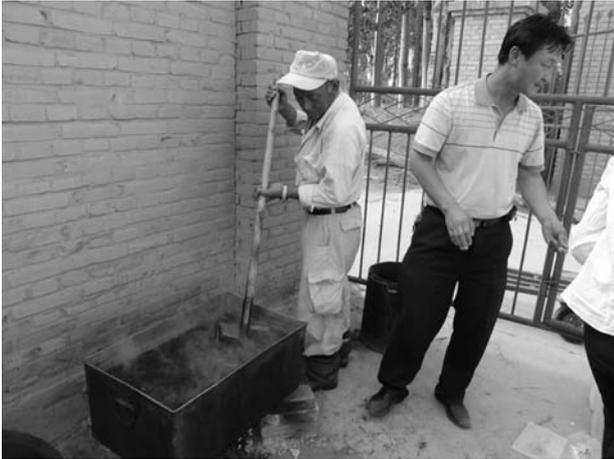
図24 ソムレ結晶を熱湯に溶かす。
